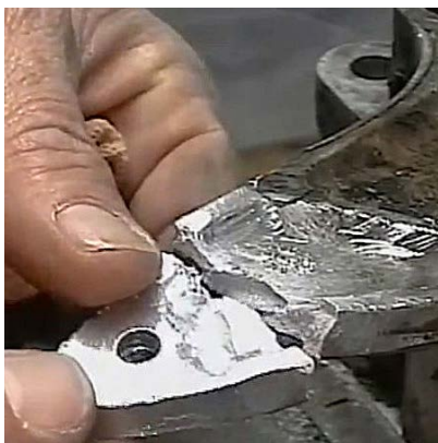
Проушина полностью потеряна Формируем заготовку и наращиваем недостающую часть детали
