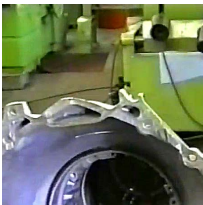
Проушина сломана только наполовину
