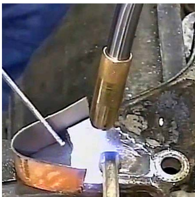
Проушина полностью потеряна Формируем заготовку и наращиваем недостающую часть детали
